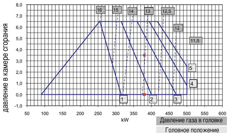
**Предупреждение:** величины предварительной калибровки определены на камерах сгорания для испытаний EN676 в идеальных условиях, и полезны при первом розжиге, но должны будут быть проверены и откорректированы с калибровкой для каждой отдельной установки.
