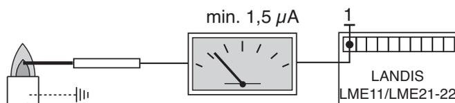
При неработающей горелке подключите микроамперметр постоянного тока со шкалой от 0 до 50 или от 0 до 100 мкА. Если регулировка выполнена правильно, то во время работы горелки сила тока должна быть не ниже 1,5 (LME 22) .
