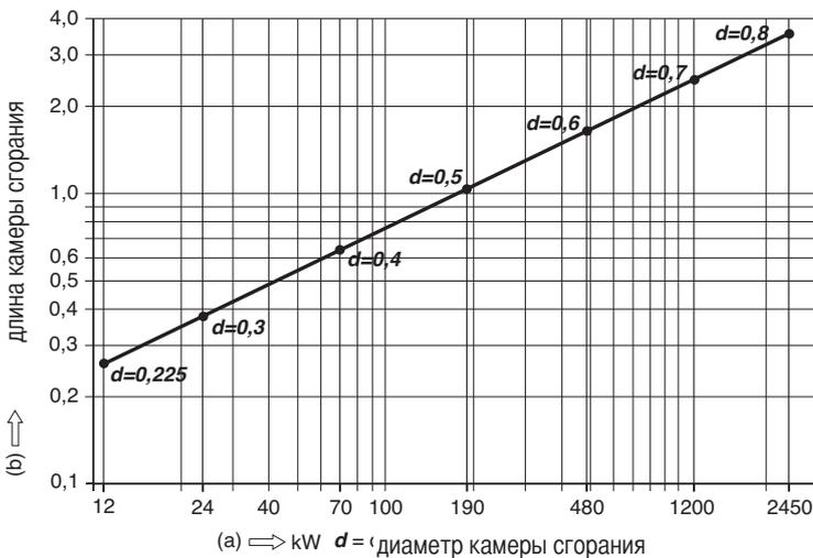
Горелки прошли испытания в камерах сгорания, соответствующих нормативам EN 676. При меньших размерах камеры сгорания следует обращаться за консультацией к производителю.
