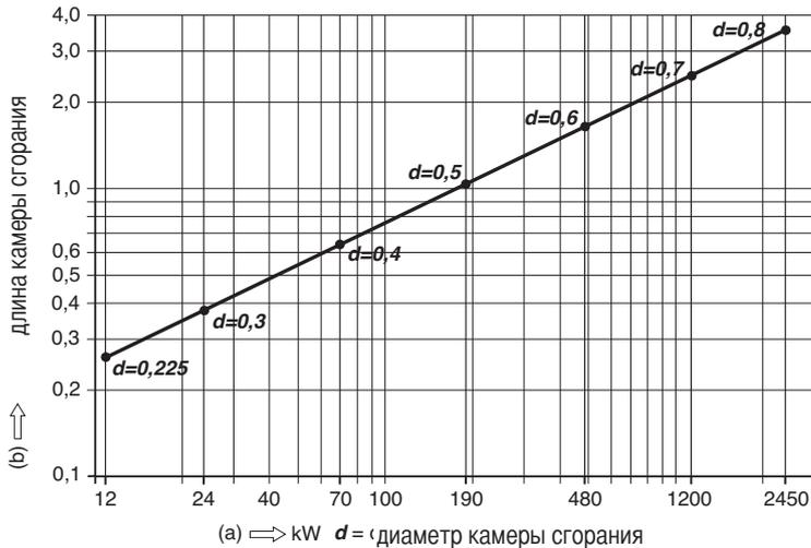
Горелки прошли испытания в камерах сгорания, соответствующих нормативам EN 676. При меньших размерах камеры сгорания следует обращаться за консультацией к производителю. **Монтаж выполнять в соответствии с местными нормами и правилами.**
