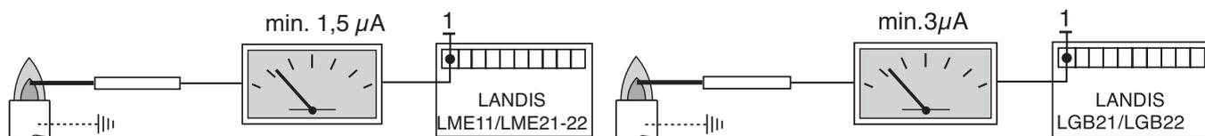
При неработающей горелке подключите микроамперметр постоянного тока со шкалой от 0 до 50 или от 0 до 100  $\mu\text{A}$ . Если регулировка выполнена правильно, то во время работы горелки сила тока должна быть не ниже 1,5 / 3  $\mu\text{A}$ .
