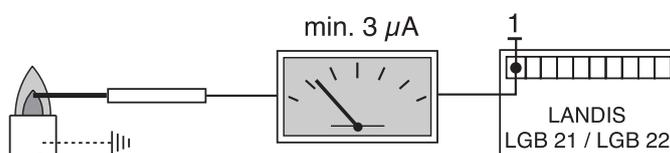
При неработающей горелке подключите микроамперметр постоянного тока со шкалой от 0 до 50 или от 0 до 100  $\mu A$ . Если регулировка выполнена правильно, то во время работы горелки сила тока должна быть не ниже 3  $\mu A$ .
